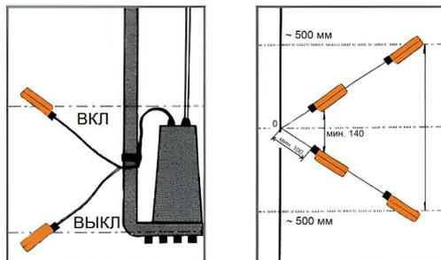
Кабель поплавкового выключателя должен быть жестко закреплен между необходимыми уровнями срабатывания.
